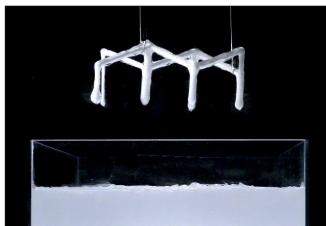
**3D-Druckverfahren ‚Rapid Liquid Printing‘, das vom MIT in Zusammenarbeit mit Steelcase entwickelt wurde:** Der Prozess ermöglicht die Herstellung von großen, individualisierten Strukturen, die aus praxistauglichen Materialien bestehen.
